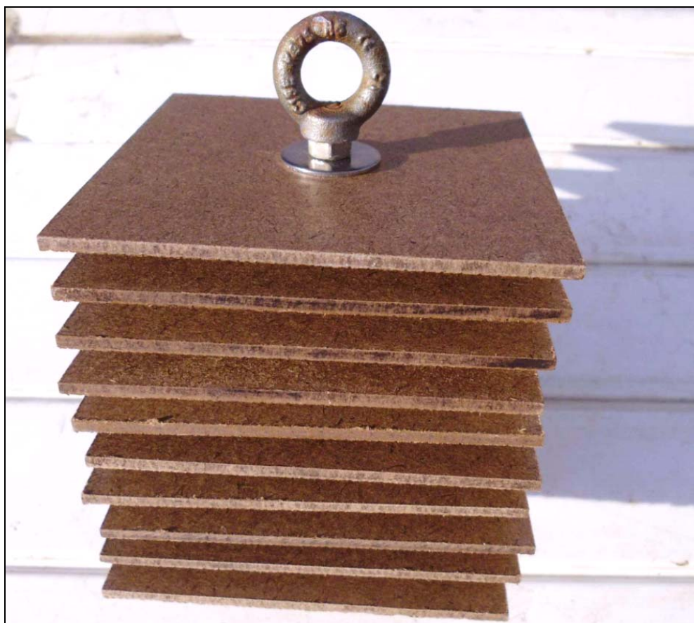
Foto 3.3 – Particolare di uno dei substrati artificiali utilizzato per il campionamento dei macroinvertebrati
